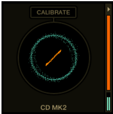
Erfolgreiche Kalibrierung mit einer Control-MK2-CD
